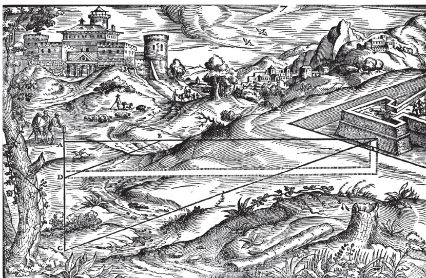
Figura 11: Lançamento de um túnel de minagem com recurso à triangulação, Gabriello Busca (1585).
